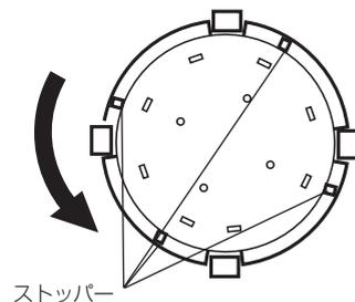
シャワープレートを上図の矢印の方向に回し、切り欠きを本体フックの位置に合わせて取り外します。
