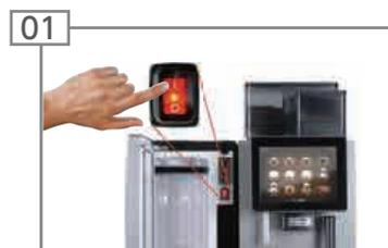
01 ドアを開け、FoamMasterの電源をオンにします。
