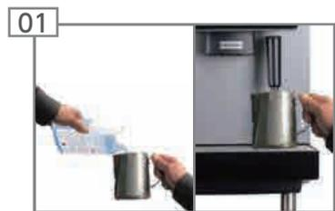
約5cmの深さになるまでコンテナに冷水と30mlの洗浄剤を注ぎます。約1分間、スチーム噴出口の下に置きます。
