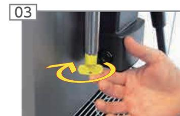
03 給湯用のジェットレギュレーターをツールで取り外し、湯垢除去を行います。
