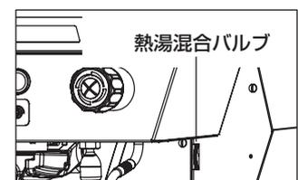
熱湯の温度は、熱湯混合バルブでも調整できます。
