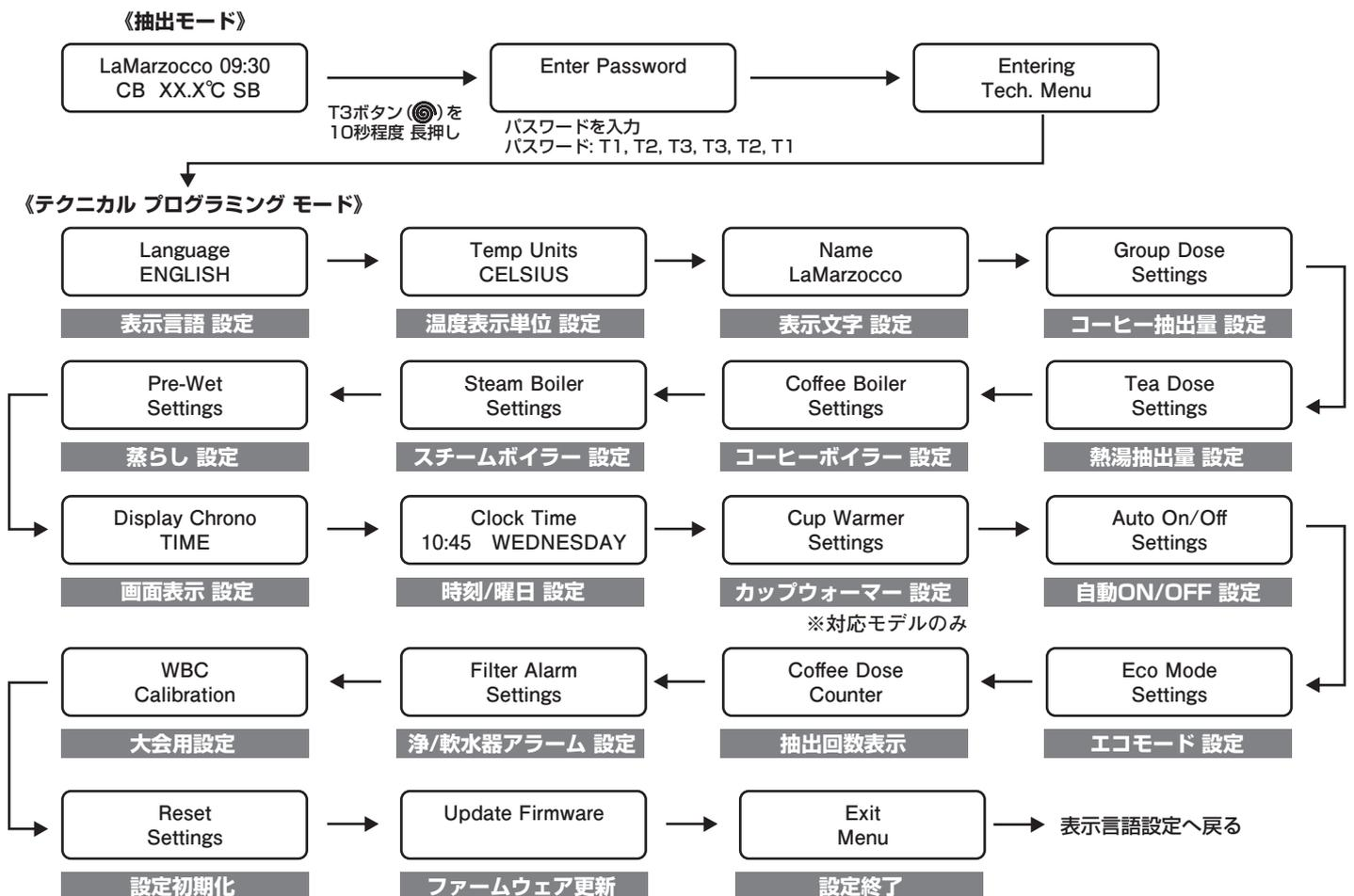
各項目の設定を行うには、設定したい項目がディスプレイに表示されている時にT3ボタンを押します。
