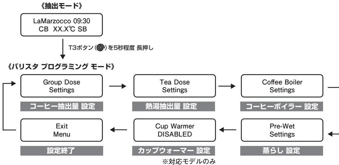
各項目の設定を行うには、設定したい項目がディスプレイに表示されている時にT3ボタンを押します。
