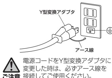
**ご注意** 電源コードをY型変換アダプタに変更した時は、必ずアース線を接続してご使用ください。
